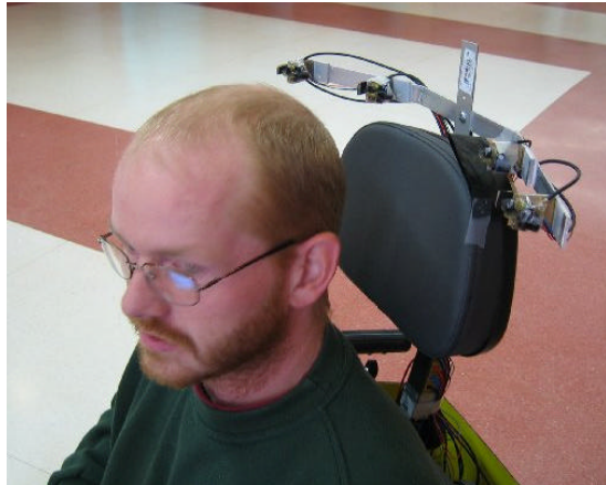
Figura 1. Disposición de los sensores en el prototipo.
