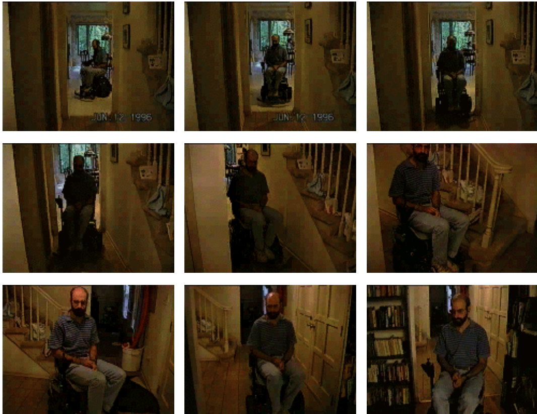
Figura 2-12: La Tin-Man en acción. Secuencia de imágenes mostrando una navegación sin intervención del usuario.
